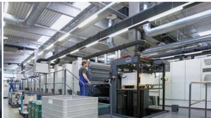
Links: zwei Beispiele für fertig gestanzte Schachteln. Rechts: Eine der vier Roland-Druckmaschinen. Über die schwarz lackierten Rohre wird die Abwärme abgeführt, die Model Kramp als Heizenergie nutzt.
