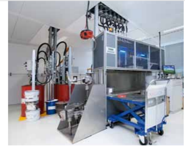
Farblabor: Eine Colorierungsmaschine mischt die Farben genau in den Anteilen, wie sie für die Herstellung einer spezifischen Schachtel benötigt werden. Hinten links sind die entsprechenden Farbfässer zu erkennen.
